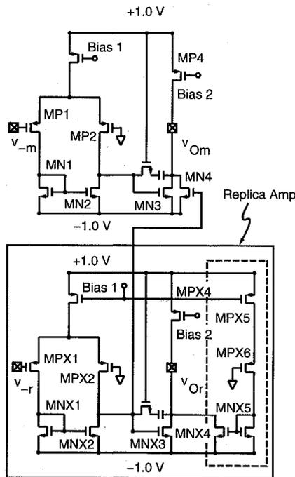
Fig. 6. Schematic of the op amp.
