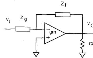
Fig. 2. An inverting op amp.
