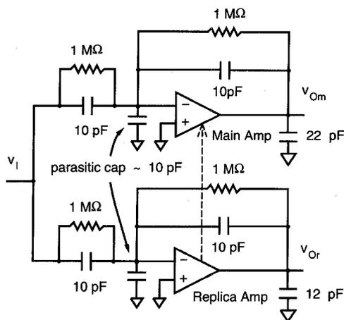
Fig. 9. Test circuit.
